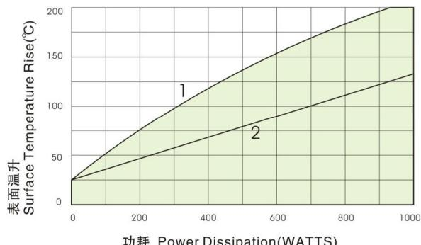
曲线1电阻器安装在标准空气冷却散热器上，25°C时水的流速为2升/分钟。
